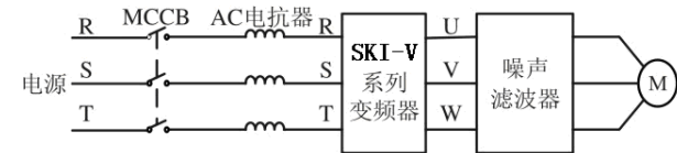
图 4-16 主回路电机侧连接图
