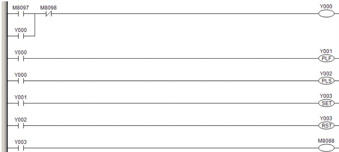
此段程序测验按键 7 (M8097) 键 8 (M8098) 按下时各输出动作, M8088 为 LED8 指示灯。
