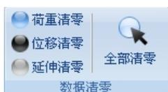
在试验前，根据实际需要，按下相应的清零按钮，对传感器进行清零。
