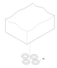
Dichtungssatz für Ventile der Nenngröße 6 mit Form A nach ISO4401-03-02-0-05 Seal kit for valve Size 6 with form A in accordance with ISO4401-03-02-0-05
