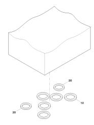
Dichtungssatz für Ventile der Nenngröße 10 mit Form B nach ISO4401-05-05-0-05 Seal kit for valve Size 10 with form B in accordance with ISO4401-05-05-0-05
