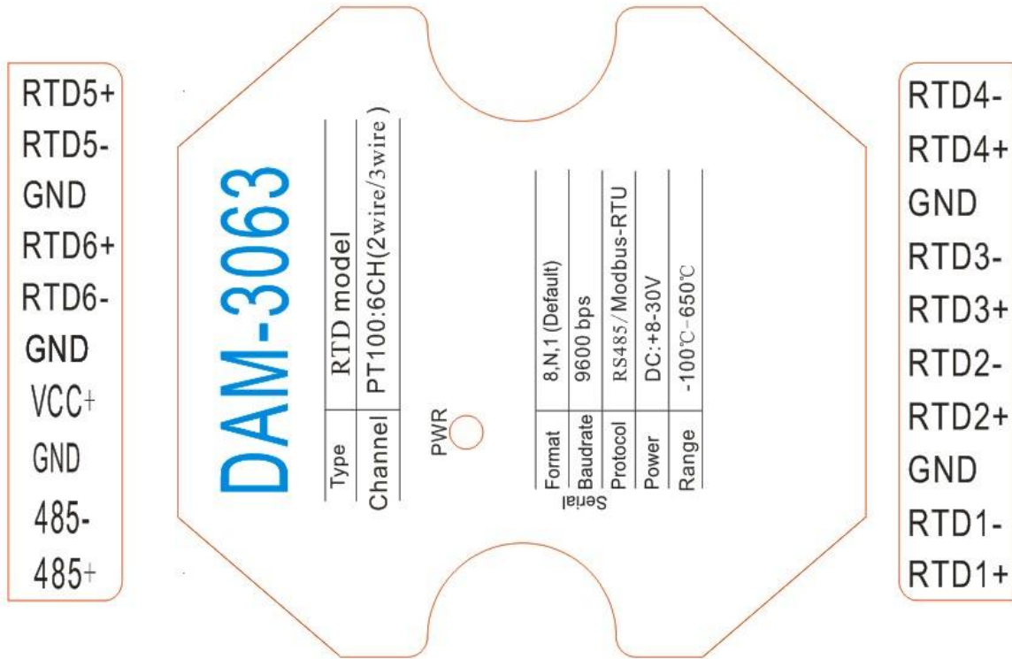
3-1 DAM-3063 模块端口位置示意图
