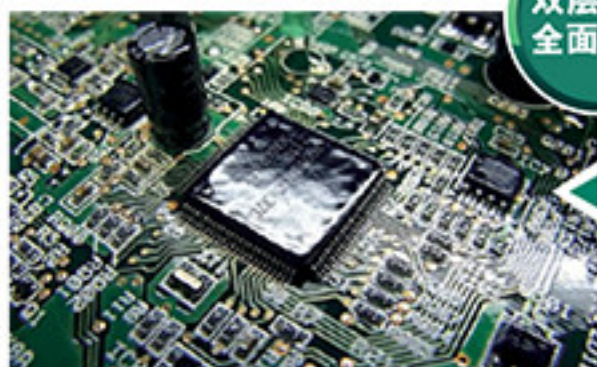
采用 SMT 封固技术的电脑控制板表面
