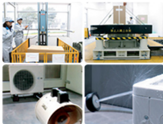
落下实验 / 振动实验 强风实验 / 雨水实验
