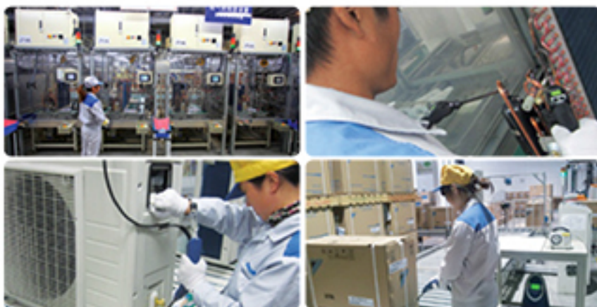
粗气密检查 / 高压 He 泄露检查 闭锁阀气密检查 / 捆包状态气密检查
