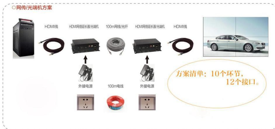
由上图可见，HDMI 网传或光端机方案虽然在一定程度上缓解了长距离音视频信号传输的困境，但也存在明显的技术性短板：
