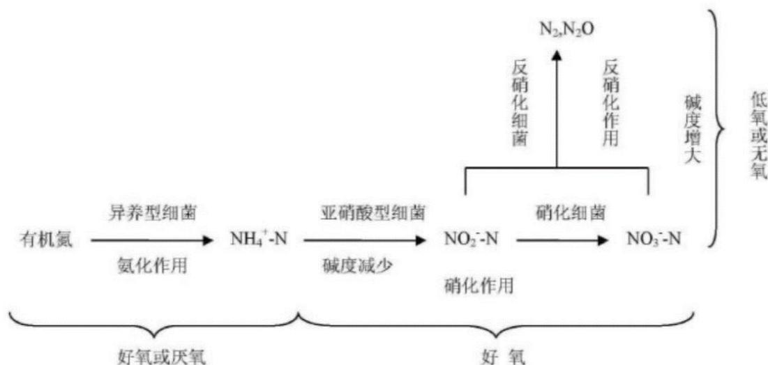
图二 印染废水总氮污染物的相互转化
