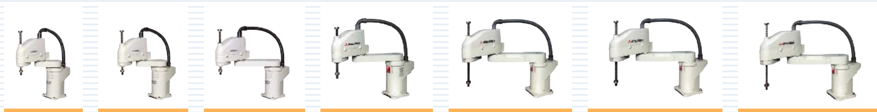
RH-6SH35 最大可搬运重量:6kg 最大动作区域半径:350mm 上/下行程:200mm (特殊规格 无尘;油雾) RH-6SH45 最大可搬运重量:6kg 最大动作区域半径:450mm 上/下行程:200mm (特殊规格 无尘;油雾) RH-6SH55 最大可搬运重量:6kg 最大动作区域半径:550mm 上/下行程:200mm (特殊规格 无尘;油雾) RH-12SDH55 (iQ Platform规格RH-12SQH55) 最大可搬运重量:12kg 最大动作区域半径:550mm 上/下行程:350mm (特殊规格 无尘;油雾) RH-12SDH70 (iQ Platform规格RH-12SQH70) 最大可搬运重量:12kg 最大动作区域半径:700mm 上/下行程:350mm (特殊规格 无尘;油雾) RH-12SDH85 (iQ Platform规格RH-12SQH85) 最大可搬运重量:12kg 最大动作区域半径:850mm 上/下行程:350mm (特殊规格 无尘;油雾) RH-18SDH85 (iQ Platform规格RH-18SQH85) 最大可搬运重量:18kg 最大动作区域半径:850mm 上/下行程:350mm (特殊规格 无尘;油雾)
