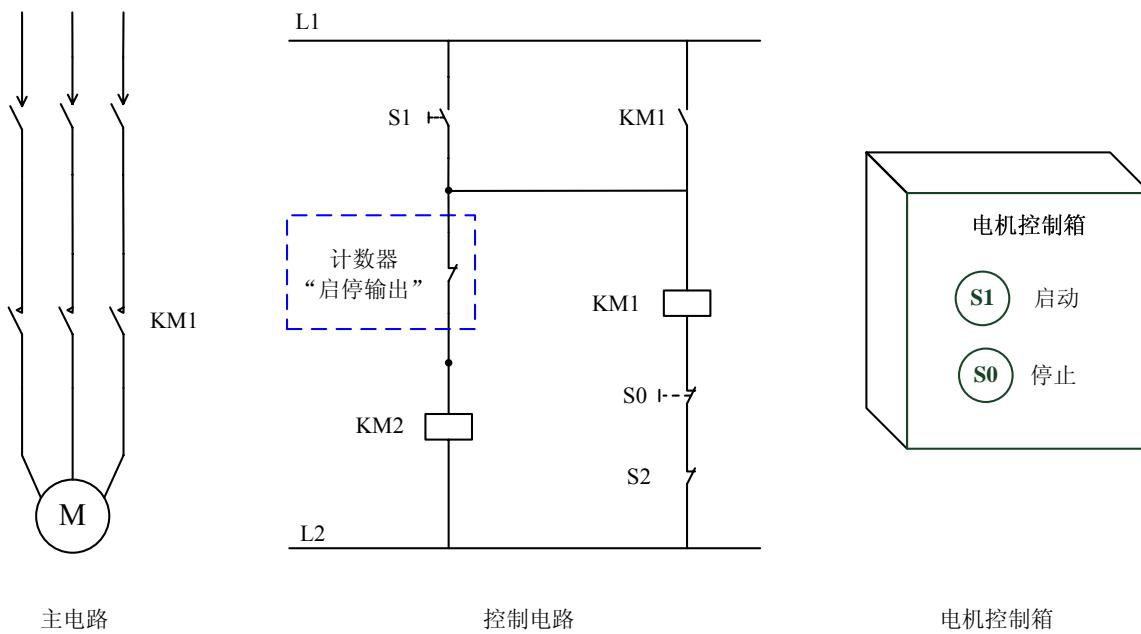
图 3 计数器用于定量装车场合时，控制皮带机接线示意图
