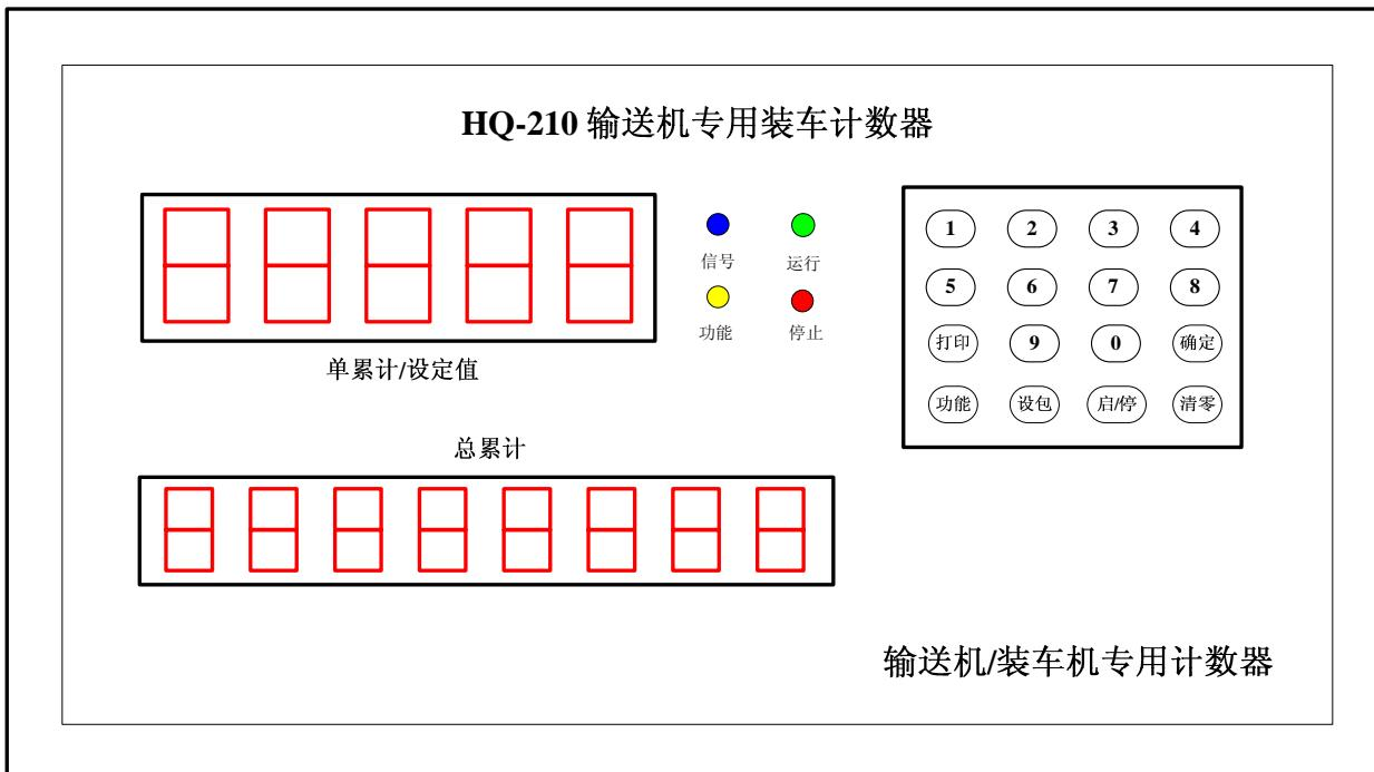
图 2 计数器主机的正面图 (尺寸 360×220×60mm)
