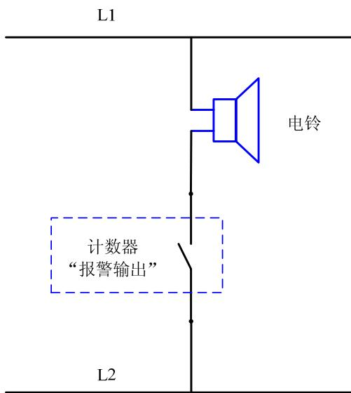
图 4 计数器用于定量装车场合时，控制电铃提前量示警接线示意图
