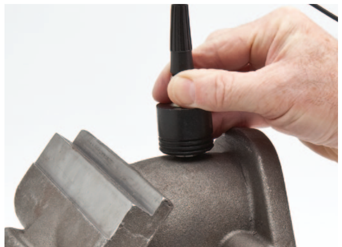
高穿透软件选项可以对很多铸造金属部件及声波衰减性强的材料进行测量。
