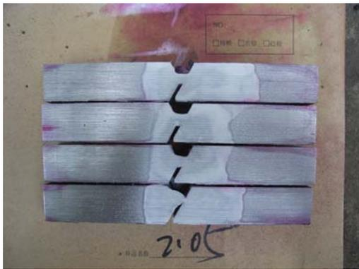
图 4 BHARD400CF-3 铁研试样裂纹检测照片
