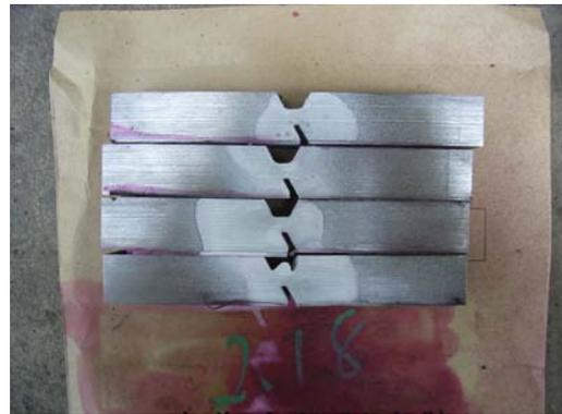
图 3 BHARD400CF -2 铁研试样裂纹检测照片
