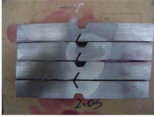
图 6 BHARD400CF-5 铁研试样裂纹检测照片
