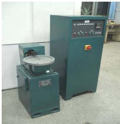
图 1 ML-100 磨粒磨损试验机照片
