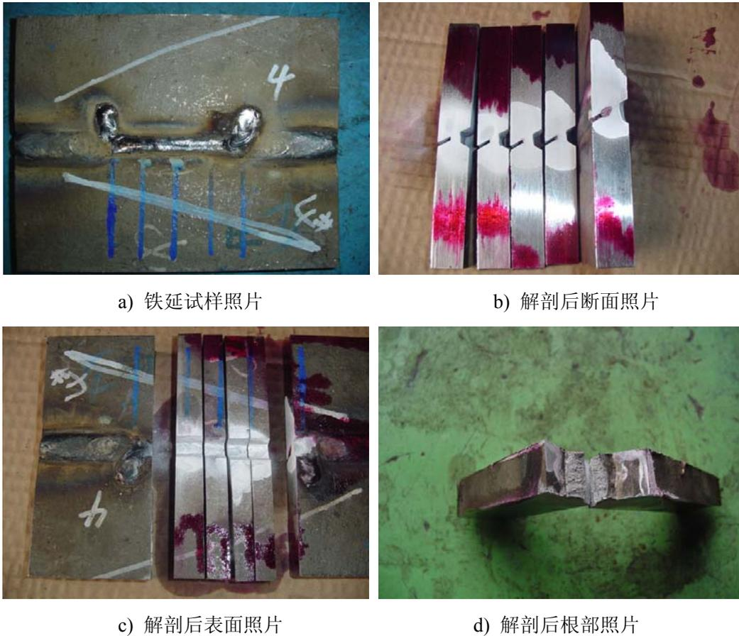
图 24 号件铁延试样及裂纹检测照片
