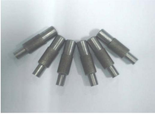
图2 耐磨测试试样实物照片
