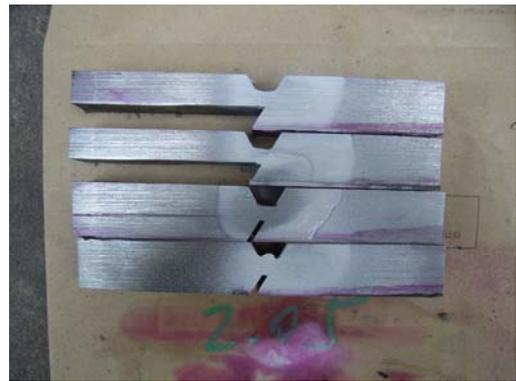
图 5 BHARD400CF-4 铁研试样裂纹检测照片
