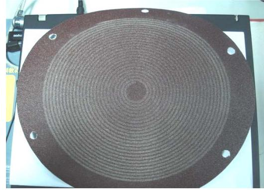
图3 耐磨测试后砂纸表面的螺旋线
