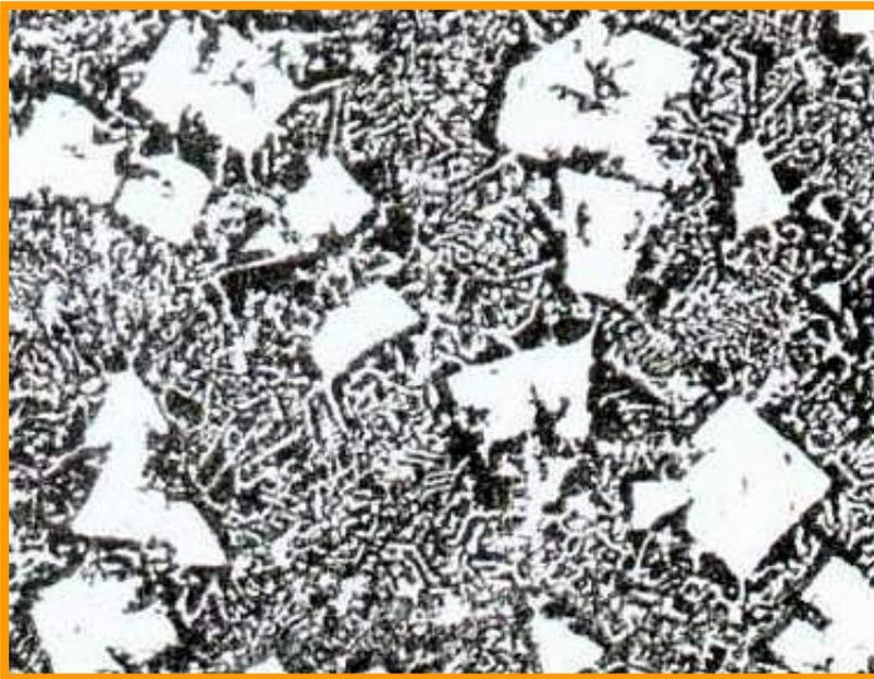
合金的铸造性能和耐磨性较好(但比锡基轴承合金低), 价格较便宜, 可用于制造中、低载荷的轴瓦, 例如汽车、拖拉机曲轴的轴承等。
