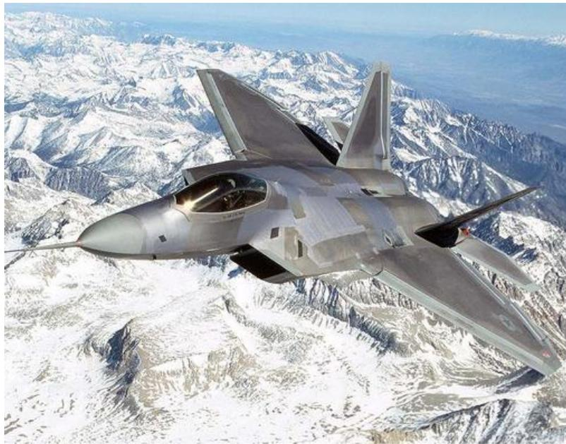
美F-22战机约36%重量的零件用钛合金制造
