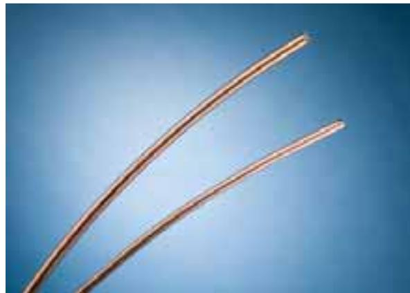
艾力高® (ERICO®) 镀铜圆钢 (CSC) 属于艾力泰® (ERITECH®) 设施电气保护产品，它是由在钢上首先镀上一层镍，再在镍层上镀上电解铜形成。这一工序确保了镀铜层与钢芯之间长效的分子联接。
