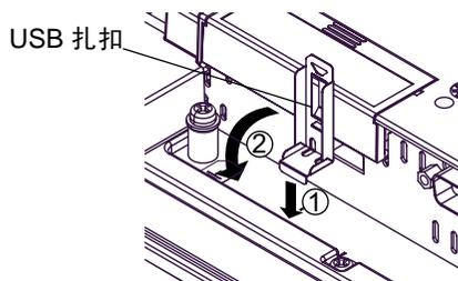
(2) 将 USB 电缆扎带穿过 USB 扎扣的桥。
