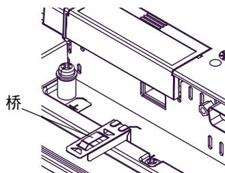
(3) 将 USB 电缆插入端口。将扎带环绕插头并将其拉紧。
