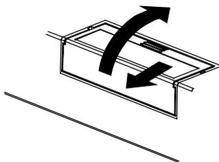
(2) 将 CF 卡插入卡槽，直到推出弹出按钮。
