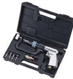
气动焊点定位钻 订货号: JHR3530-2 长度: 284mm 重量: 2.1公斤 耗气大小: 380升/分钟 空转转速: 2000r.p.m 胶盒装, 带2寸定位钩, 5支钻头 微型油雾器, 旋转接头
