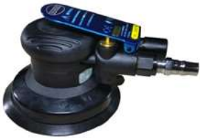
5寸静音大偏心粗磨砂光机 订货号: HR4020N 底盘直径: 125mm 偏心大小: 8mm 耗气大小: 60升/分钟 空转转速: 12000r.p.m 磨机重量: 0.7公斤 粘扣120号以下粗砂纸打磨
