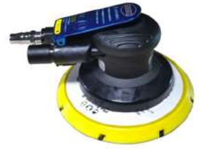
6寸静音大偏心粗磨砂光机 订货号: HR4021N 底盘直径: 150mm 偏心大小: 8mm 耗气大小: 60升/分钟 空转转速: 12000r.p.m 磨机重量: 0.73公斤 粘扣120号以下粗砂纸打磨
