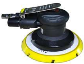
6寸静音中偏心砂光机 订货号: HR8102N 底盘直径: 150mm 偏心大小: 5mm 耗气大小: 60升/分钟 空转转速: 12000r.p.m 磨机重量: 0.73公斤 粘扣400号以下砂纸打磨
