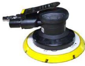
6寸静音小偏心精细砂光机 订货号: HR8101N 底盘直径: 150mm 偏心大小: 2.5mm 耗气大小: 60升/分钟 空转转速: 12000r.p.m 磨机重量: 0.73公斤 中途底漆和超精细平面打磨抛光
