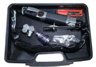
气动汽车切割锯 订货号: HR3526-2 长度: 235mm 重量: 0.54公斤 耗气大小: 200升/分钟 空转转速: 9000r.p.m 往复行程: 10mm 切割能力: 1.5mm以下 胶盒套装, 含24和32齿锯片各5片 排气消音管, 旋转接头, 微型油雾器
