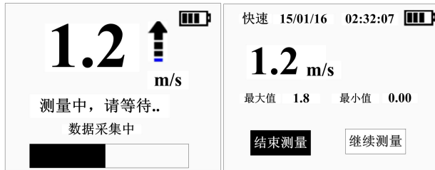
图 25c 测量中，显示瞬时速度 图 25d 测量完成界面
