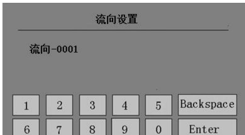
**流向设置：**0000 双向测量显示；0001 正测量显示；0002 负流量测量显示。（默认0001）
