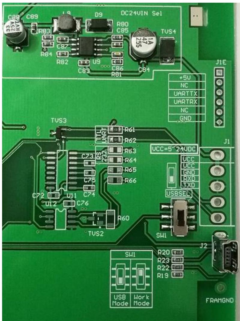
SW1 即为模式切换拨码开关，上图中，当拨码开关拨往下时，也即为 USB 模式。需要注意，EzUIH101 模块可从 USB 口取电，但建议仅当模块处于 USB 模式时方可由 USB 口给模块供电。
