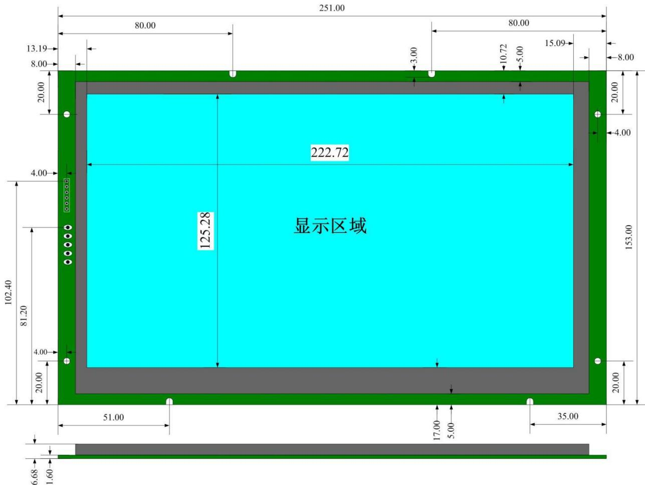
上图标识数据单位为 mm, EzUIH101 四个圆形定位孔与四角对称, 孔径为 3mm; 模块上下边沿 PCB 上开有四个半圆型定位孔, 孔径 3mm。
