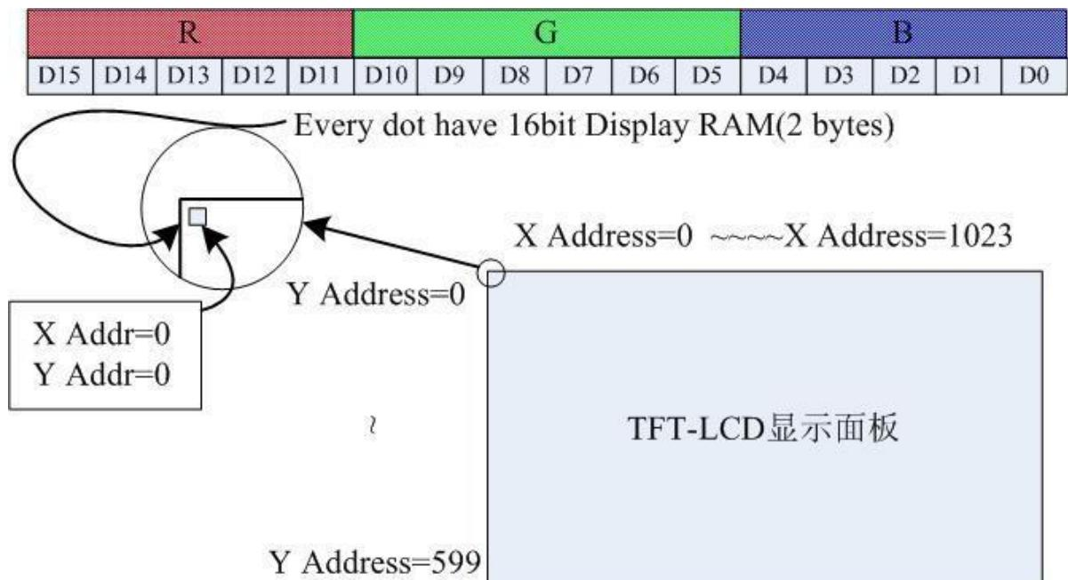
触摸版的 EzUIH101 模块将触摸面板集成于模块之中，在出厂前已经过校对，在屏幕显示的有效区域内，触摸的点的位置数据也以 X 轴、Y 轴坐标表示；X 轴从 0~1023，Y 轴从 0~599，与模块的显示屏的坐标一样。
