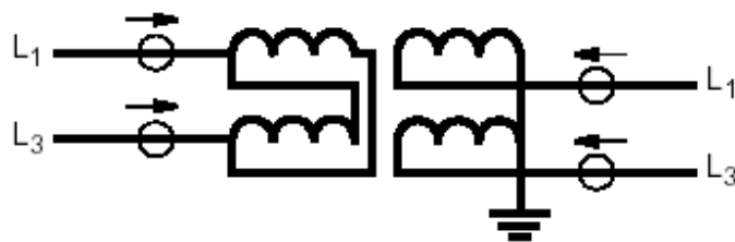
图2-21 带电流定义的单相变压器举例
